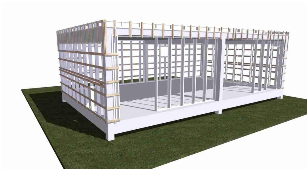
Figura 11 – modelo esquemático da perfilaria para fachada ventilada
